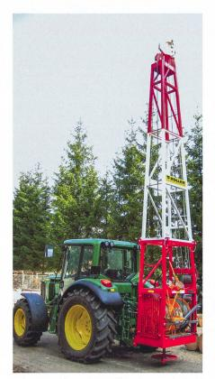
Les appareils à mât basculant permettent aussi de travailler sur les pentes raides.
