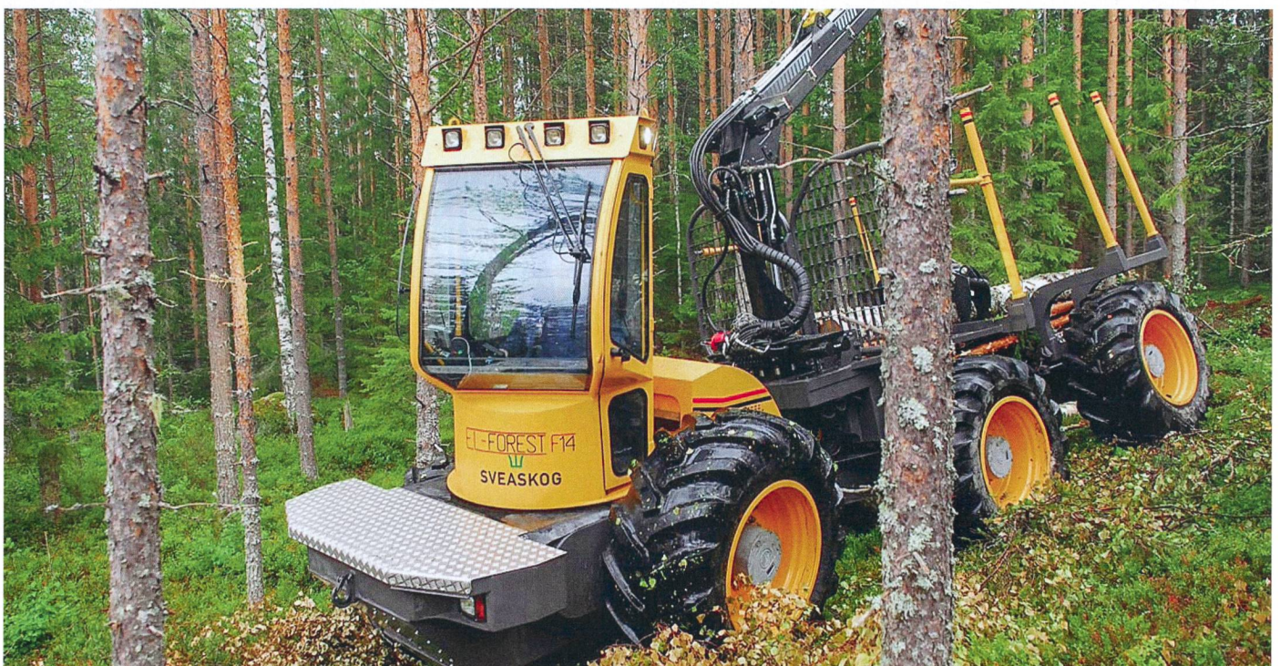
La partie électrique de la transmission hybride de « El Forest » est alimentée par des batteries au lithium. Photo: El Forest
