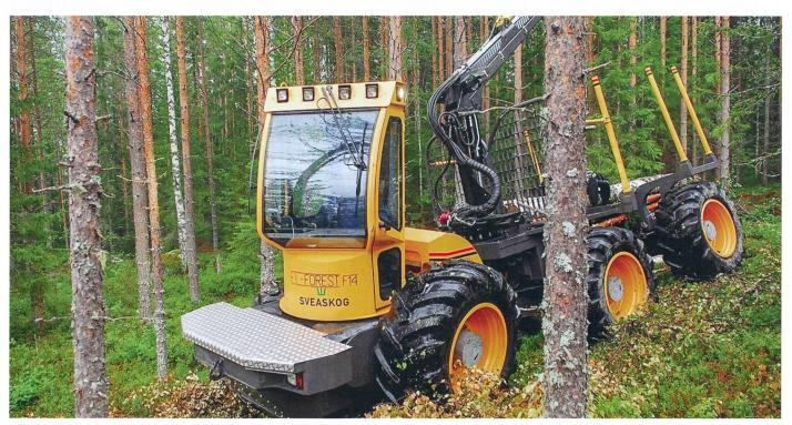
La partie électrique de la transmission hybride de «El Forest» est alimentée par des batteries au lithium. Photo: El Forest
