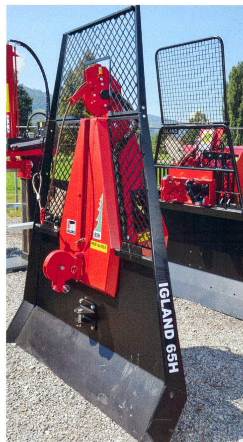
Le réglage en hauteur de la poulie d'entrée s'effectue sans problème par le biais d'un circuit à simple effet. Photo : Ruedi Hunger
