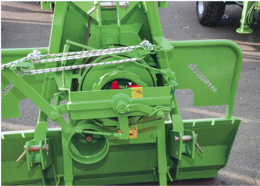
Les treuils simples possèdent des commandes manuelles. Inconvénient : l'opérateur est planté dans une zone relativement dangereuse. Photo : Ruedi Hunger
