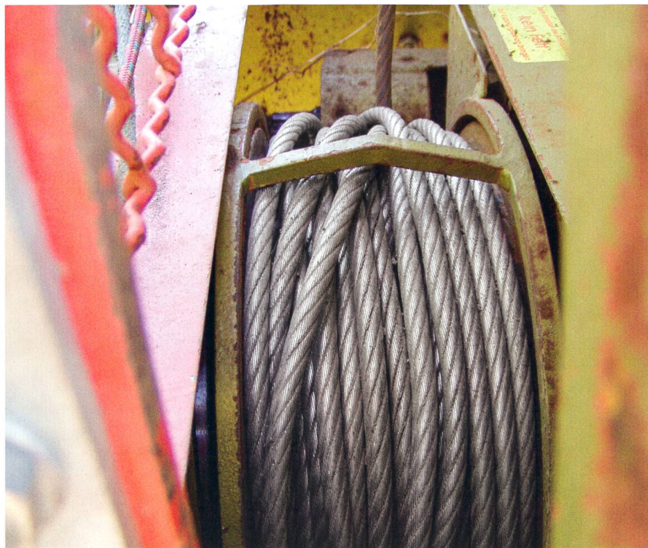
Un enroulement mal contrôlé du câble a une incidence négative sur sa durée de vie.
