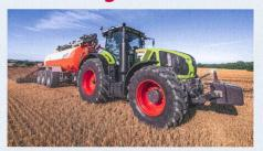
A la fin 2017, les gros « Axion 900 » passeront aussi à une nouvelle génération présentant des moteurs plus puissants, un concept de travail à régime réduit ainsi que les finitions « Cis+ » et « Cebis ». La puissance maximale du modèle le plus puissant, l'« Axion 960 » passera de 325 et 445 ch. Le nouveau concept de travail à régime réduit permet au moteur d'afficher un
