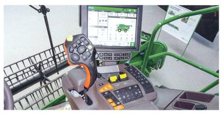
Un nouveau levier de commande et un écran analogue à la technique actuelle des smartphones, mais surtout les nouvelles possibilités électroniques permettent de mieux exploiter la puissance installée de la machine.
