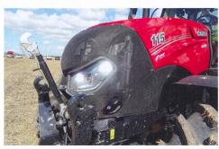
Un capot inédit avec davantage d'entrées d'air pour les unités de refroidissement et de nouvelles options d'éclairage avec projecteurs halogènes ou LED à commutation individuelle sont les marques distinctives des nouveaux tracteurs «Maxxum».
