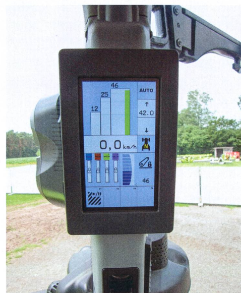
L'affichage standard de l'écran couleur «Cis+» intégré dans le montant A offre une bonne visibilité des réglages actuels des trois plages de vitesse virtuelles.
