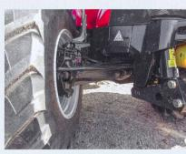
Les modèles « Puma 185 » à « 240 » sont équipés d'une suspension de l'essieu avant améliorée, avec double accumulateur de pression, qui offre un débattement supérieur et, en même temps, une augmentation du poids total admissible de 13 650 kg pour le « Puma » et de 14000 kg pour le « Puma CVX». En outre, la direction adaptative et réactive est disponible. Celle-ci permet d'ajuster le nombre de tours de volant et l'angle de braquage des roues avant. Cette
