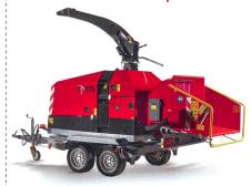
La déchiqueteuse à disques Linddana «TP 275 Mobil», montée sur remor-
