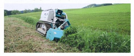
Un an après sa sortie, le chenillard forestier autonome Pflanzelt « Moritz » se voit doté de plusieurs innovations. Le treuil de débardage intégré est désormais démontable en quelques minutes, et ce sans outils. Ce véhicule se transforme alors en
