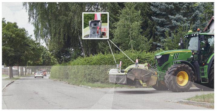
Les choses bougent au sujet du porte-à-faux avant. S'il dépasse les 4 m à l'avant, à compter du milieu du guidon, il suffira peut-être à l'avenir d'équiper les outils portés frontaux d'un système de caméra. Photo: Fliegl
