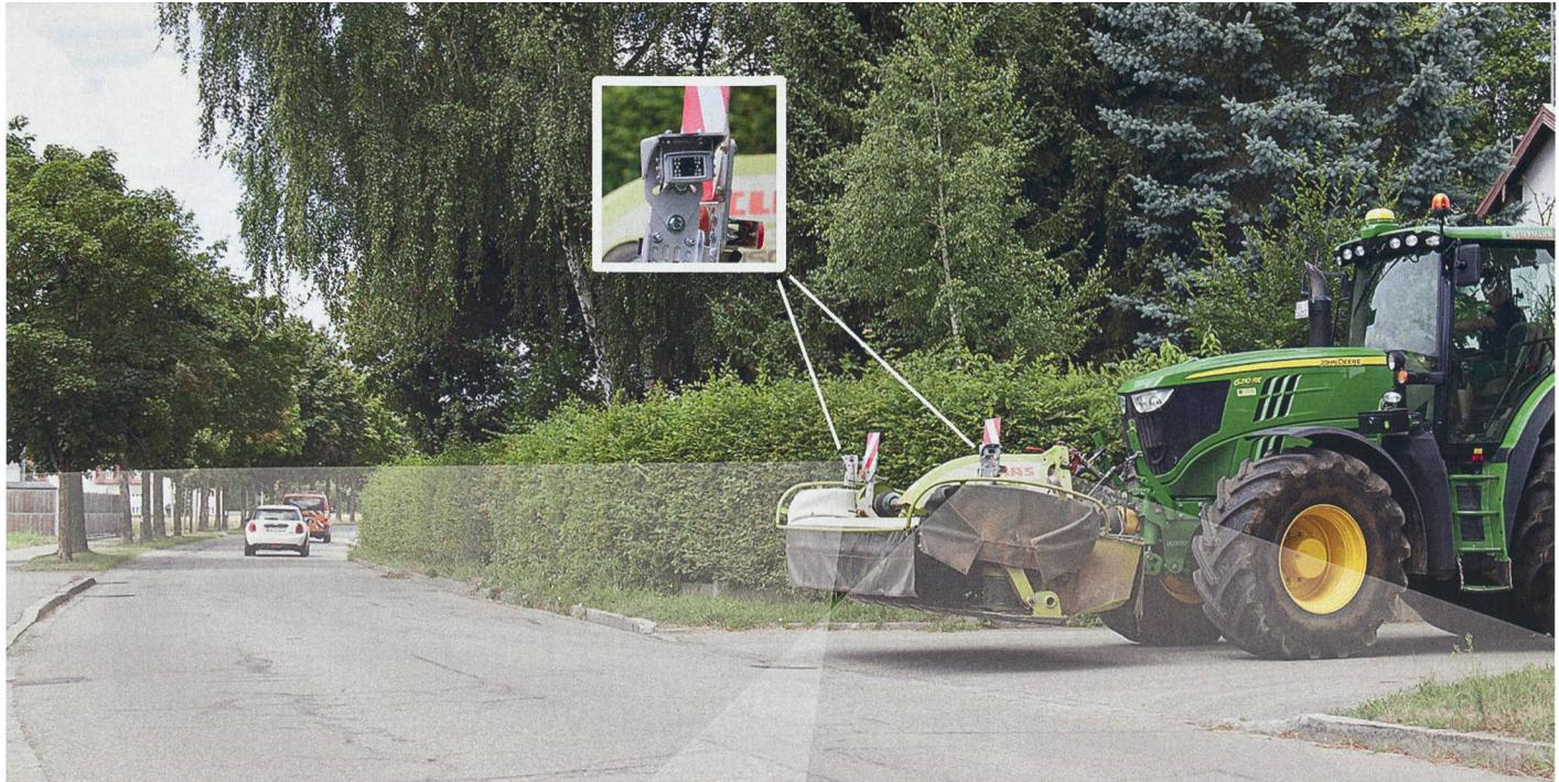
Les choses bougent au sujet du porte-à-faux avant. S'il dépasse les 4 m à l'avant, à compter du milieu du guidon, il suffira peut-être à l'avenir d'équiper les outils portés frontaux d'un système de caméra. Photo: Fliegl
