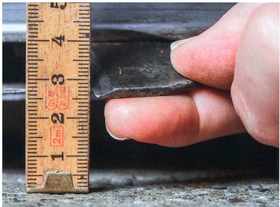
Pour des chaumes de 6 à 7 cm de hauteur, il faut une distance d'environ 3 cm entre la lame et le sol. Photo : Joachim Sauter, Agroscope
