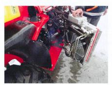
Après la dépose du capot, le radiateur se pivote pour le nettoyage, offrant ainsi un bon accès aux composants du moteur.
