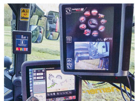
Vicon propose le terminal « IsoMatch Tellus » (à droite). La machine peut se commander également au moyen du terminal Isobus du tracteur (à gauche).
