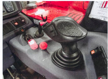
Dans la cabine, on trouve le célèbre joystick «JSM» qui commande le bras et la transmission.
