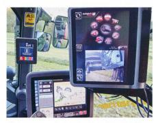
Vicon propose le terminal «IsoMatch Tellus» (à droite). La machine peut se commander également au moyen du terminal Isobus du tracteur (à gauche).
