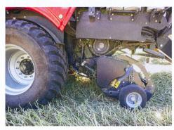
Le pick-up de 220 cm de large s'adapte bien aux irrégularités du sol et prélève le fourrage proprement. Après le rotor, celui-ci passe dans l'une des chambres de pressage.
