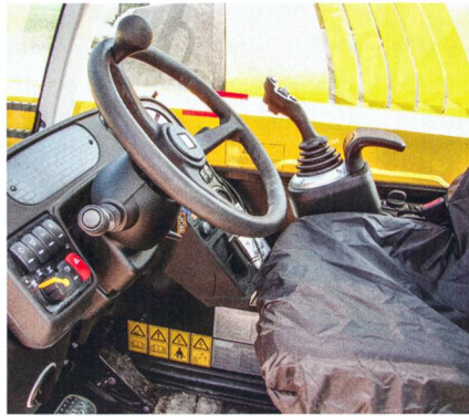
A droite du joystick et de l'accoudoir se trouve la manette d'accélération et la molette pour définir la plage de vitesse.
