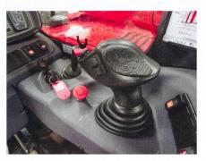
Dans la cabine, on trouve le célèbre joystick «JSM» qui commande le bras et la transmission.
