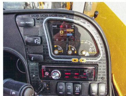
Le tableau d'affichage est placé à droite du volant. D'autres indicateurs se trouvent devant. Un contrôleur d'état de charge est intégré dans le montant droit de la cabine.
