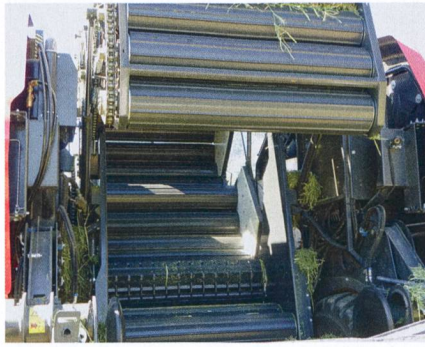
Aperçu de la vie intérieure : la chambre de pressage antérieure est visible au travers du segment de rouleaux quadruple. A l'arrière, la chambre de pressage principale.
