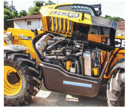
Le moteur a été spécifiquement construit pour tenir dans un logement compact, ce qui assure une bonne visibilité vers la droite.
