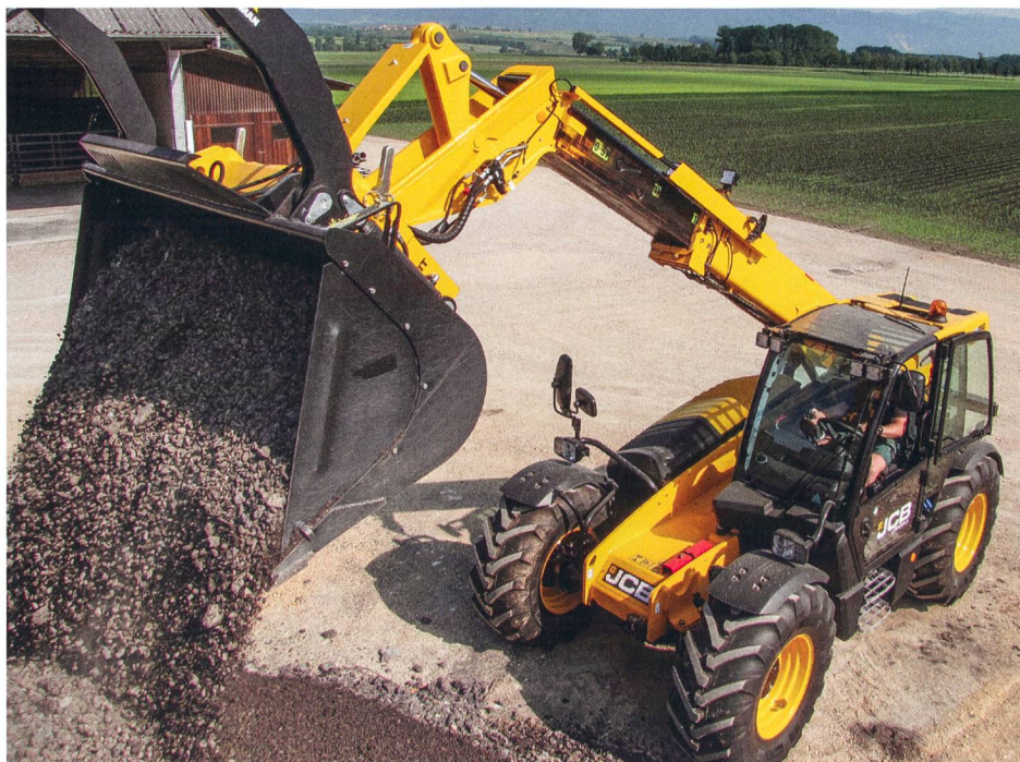
La cabine aux surfaces vitrées généreuses offre une bonne visibilité sur les outils de travail lorsqu'ils sont relevés. Photos: R. Burkhalter
