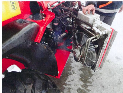
Après la dépose du capot, le radiateur se pivote pour le nettoyage, offrant ainsi un bon accès aux composants du moteur.
