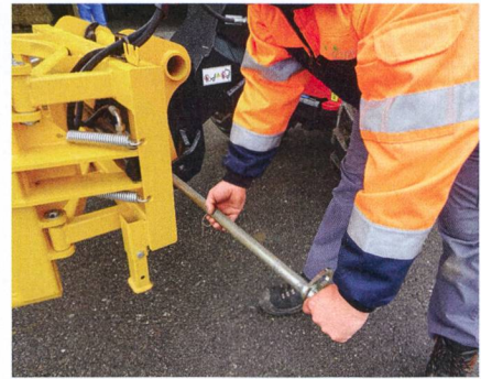
La barre de verrouillage doit être installée manuellement et assurée au moyen d'une goupille.
