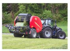
Pour assurer une reprise sûre des balles. le cadre d'enrubannage est abaissé avec un dispositif d'attelage en parallélogramme.
