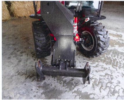
A l'avant du bras, l'attelage est légèrement coudé pour permettre la position centrale des outils.
