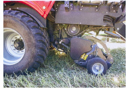
Le pick-up de 220 cm de large s'adapte bien aux irrégularités du sol et prélève le fourrage proprement. Après le rotor, celui-ci passe dans l'une des chambres de pressage.
