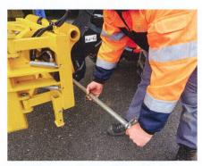
La barre de verrouillage doit être installée manuellement et assurée au moyen d'une goupille.
