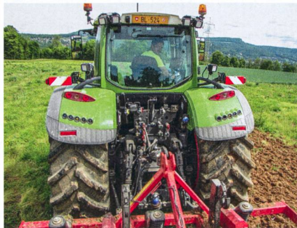
Jusqu'à cinq distributeurs sont disponibles à l'arrière. la force de levage atteint 10360 daN.
