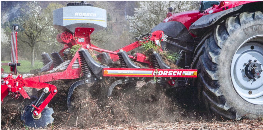
Les cultivateurs ont plus de pression avec l'augmentation de la profondeur de travail, ce qui se répercute sur l'outil suiveur. La résistance au roulement et les besoins en puissance augmentent en conséquence. Photo : Ruedi Hunger
