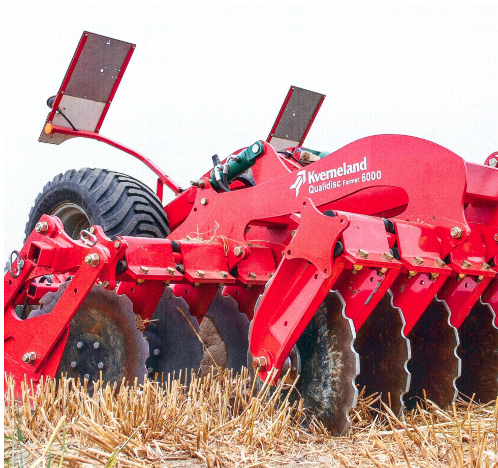
Les herse à disques compactes nécessitent un peu moins de puissance de traction. Avec davantage de profondeur de travail, l'effet de raffermisssement diminue et la paille est mieux enfouie. Photo: Kverneland
