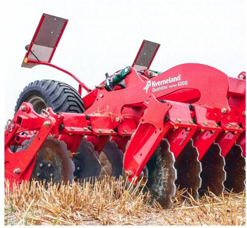
Les herses à disques compactes nécessitent un peu moins de puissance de traction. Avec davantage de profondeur de travail, l'effet de raffermissement diminue et la paille est mieux enfouie. Photo: Kverneland
