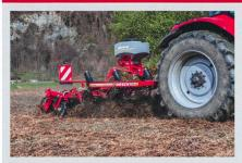
Les déchaumeuses se distinguent par la hauteur de leur châssis qui détermine le dégagement utile pour limiter les bourrages. La disposition des dents, en deux, trois ou quatre rangées, est un autre signe distinctif. Ce critère et l'espace entre les outils est déterminant pour le flux des résidus de récolte, d'engrais vert ou de la terre. Autre critère de différenciation: les outils pour égaliser et, enfin, rappuyer le sol.
