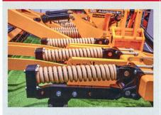
Comparé aux disques rotatifs, les dents qui plongent dans la profondeur du sol subissent des efforts bien plus élevés. Des sécurités sont prévues pour faire face aux chocs provoqués par des pierres ou d'autres obstacles. Les boulons de cisaillement sont les dispositifs les plus simples. Des systèmes hydrauliques ou mécaniques à ressorts offrent des protections individuelles plus élaborées.
