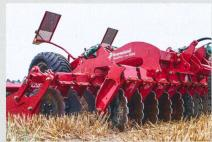
Les disques crénelés, au contraire des disques lisses, sont plus agressifs vis-à-vis de la surface du sol. L'agressivité d'un disque dépend de son diamètre, de la forme de sa denture et de l'angle d'attaque. Il y a une corrélation entre agressivité et profondeur de travail. Plus un disque est grand, plus sa vitesse de rotation diminue; c'est proportionnel, et, du coup, la surface du sol est moins intensément émiettée.
