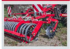
Les déchaumeurs à dents intervenant en profondeur subissent une contrainte plus élevée et la pression sur l'outil suiveur augmente. Il en résulte une plus forte résistance au roulement, provoquant un effort de traction plus élevé.
