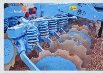
Les éléments rotatifs d'une herse à disques sont moins soumis à des contraintes et aux chocs que des outils à fixation rigide. Les supports des disques sont couramment fixés au châssis par des amortisseurs en élastomère. Les constructeurs de herses à disgues de plus grands diamètres, qui plongent plus profondément dans le sol, équipent leurs machines de sécurités anti-surcharge.
