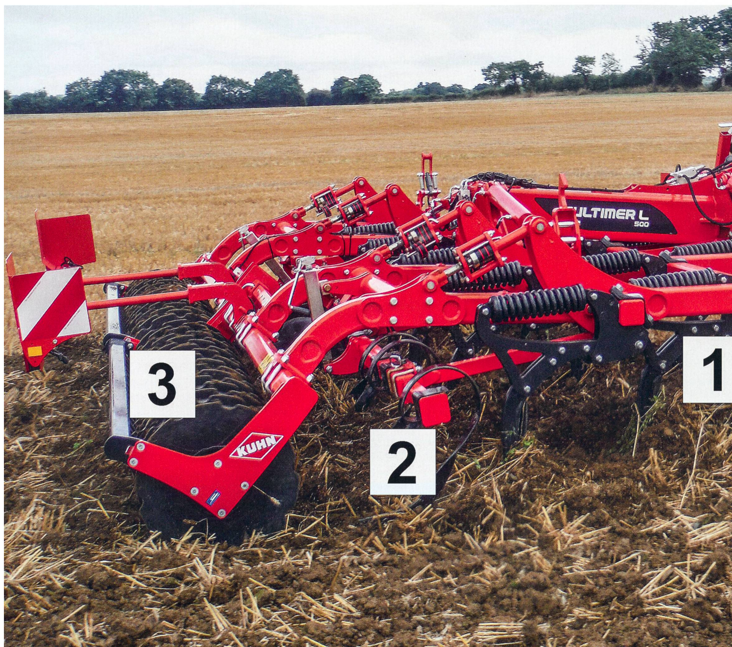
Les déchaumeurs de 3 mètres de large restent les plus courants. 1 = Dents disposées en ordres divers. 2 = Outils pour égaliser la surface du sol. 3 = Outil de rappuyage. Photo : Kuhn et Ruedi Hunger
