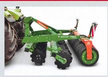
Plus elles travaillent profond, moins les déchaumeuses à disques exercent de pression sur les outils suiveurs, du fait que les disques supportent une part plus élevée du poids de la machine. En principe, tous les types de rouleaux peuvent être utilisés avec une déchaumeuse à disques. Le rouleau cage est le plus fréquemment proposé en série. Les rouleaux à anneaux constituent une alternative. Sur les machines portées, le poids est généralement un critère de choix déterminant.
