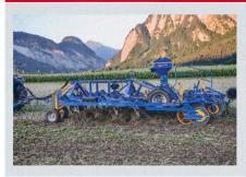
En fonction de leur largeur et du tracteur à disposition, les déchaumeuses à dents et à disques peuvent être portées, traînées ou semi-portées. Les modèles portés exigent un relevage hydraulique puissant, un tracteur de poids élevé, correspondant à leur largeur de travail, à leur porte-à-faux (longueur) et à leur masse. Une simple roue de transport permet de diminuer ces contraintes.
