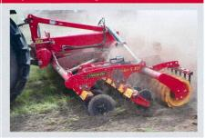
Le diamètre des disques s'étend de 460 à 736 mm. Plus il est petit, plus le disque convient aux façons superficielles (jusqu'à 10 cm de profondeur). La vitesse de rotation périphérique plus élevée provoque un meilleur émiettement. Les disques de 510 à 530 mm sont dits « universels », ceux de 630 mm conviennent bien dans les chaumes de maïs et ceux de 736 mm permettent d'incorporer les plantes de maïs grain sur tout l'horizon.
