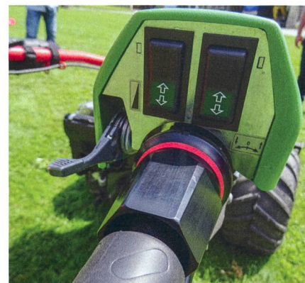
Le poste de commande est celui du système hydraulique supplémentaire, requis par certains accessoires.
