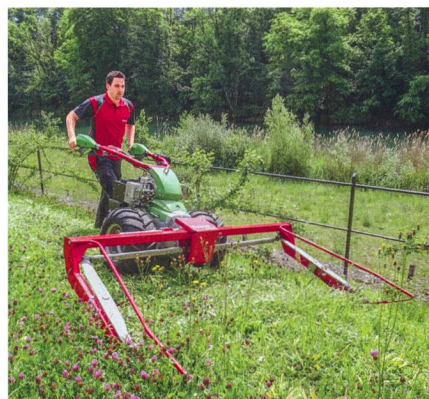
Le «Varea» est équipé d'un moteur Subaru-Robin de 14 ch et d'une transmission hydrostatique.
