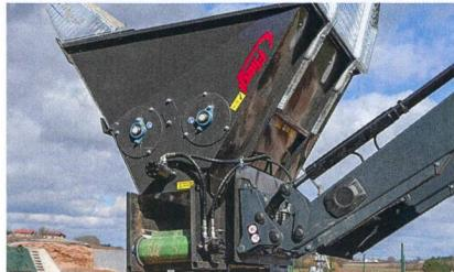
Fliegl propose un godet pailleur capable de saisir et de traiter une balle rectangulaire complète. Il est équipé de trois tambours de fraisage différents qui
