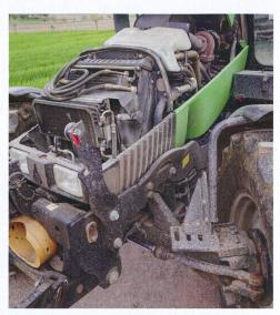
L'accès au moteur est aisé, l'essieu avant est équipé d'une commande automatique 4×4.
