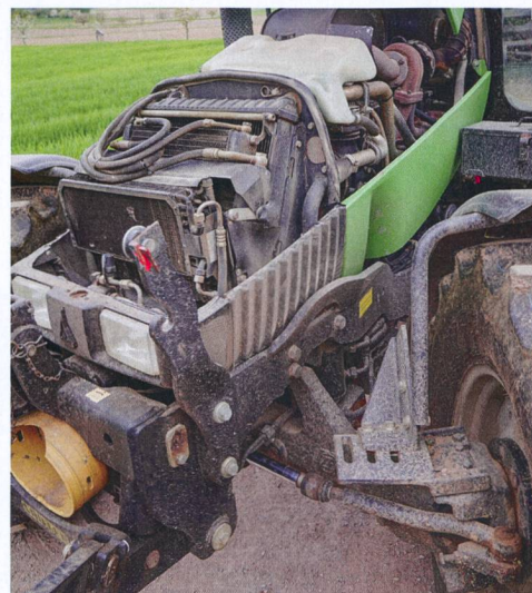
L'accès au moteur est aisé, l'essieu avant est équipé d'une commande automatique 4x4.
