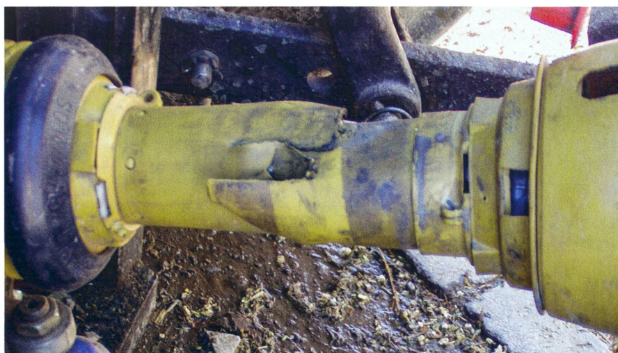
Ce sont les prises de forces courtes, attelées à de lourdes machines qui posent encore des difficultés.
