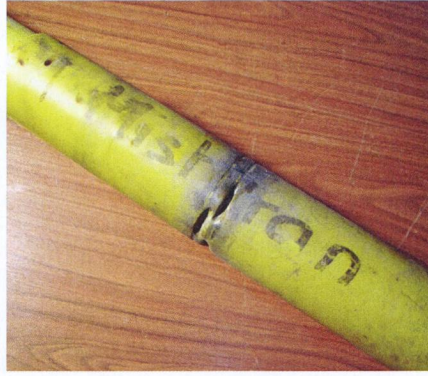
Le début de la fin – image typique d'un dégât lorsque l'on ne retire pas le support de remisage.
