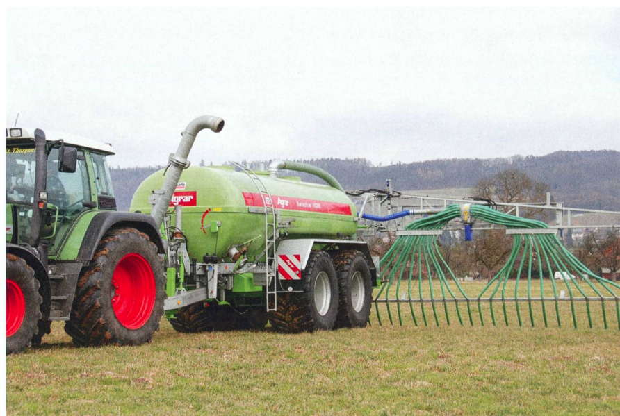
Le recours aux techniques sophistiquées telles que la rampe à pendillards ou le purinage par tuyaux donne l'avantage aux agro-entrepreneurs, tandis que l'épandage de lisier classique en régie propre reste économiquement intéressant. Photo: R. Engeler
