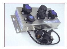
«All in one», le convertisseur de tension pour les systèmes «ABS» / «EBS» et pour l'éclairage de la remorque. Il est nécessaire de changer les ampoules des feux de la remorque. Si une remorque est utilisée avec plusieurs tracteurs, il est possible d'installer un convertisseur de tension sur la remorque ou de s'équiper d'un système mobile.
