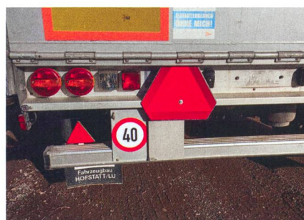
Obligatoire : le disque 40 km/h se place à l'arrière de la remorque.
