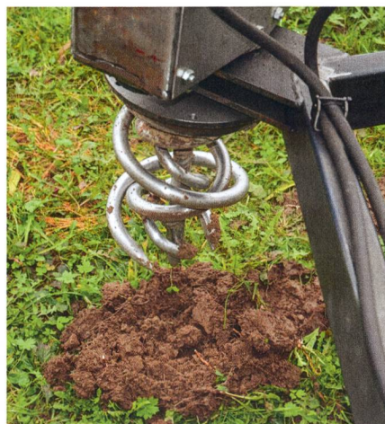
Le «Blackenzwirbel» fonctionne avec des organes arracheurs en rotation à la manière d'un tire-bouchon.
