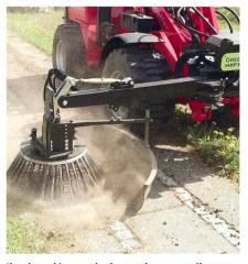
Il existe désormais de nombreux outils pour le désherbage mécanique à l'aide de brosses, à monter sur un «valet de ferme», un mono-axe ou d'autres véhicules porteurs.
