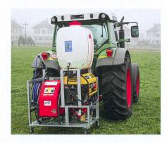
La version pour attelage trois points de l'éradicateur de rumex de Bachmann est montée sur un châssis métallique.
