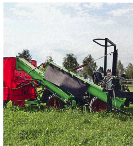
Cette variante du «Wuzi» possède une trémie pour l'évacuation des racines arrachées.
