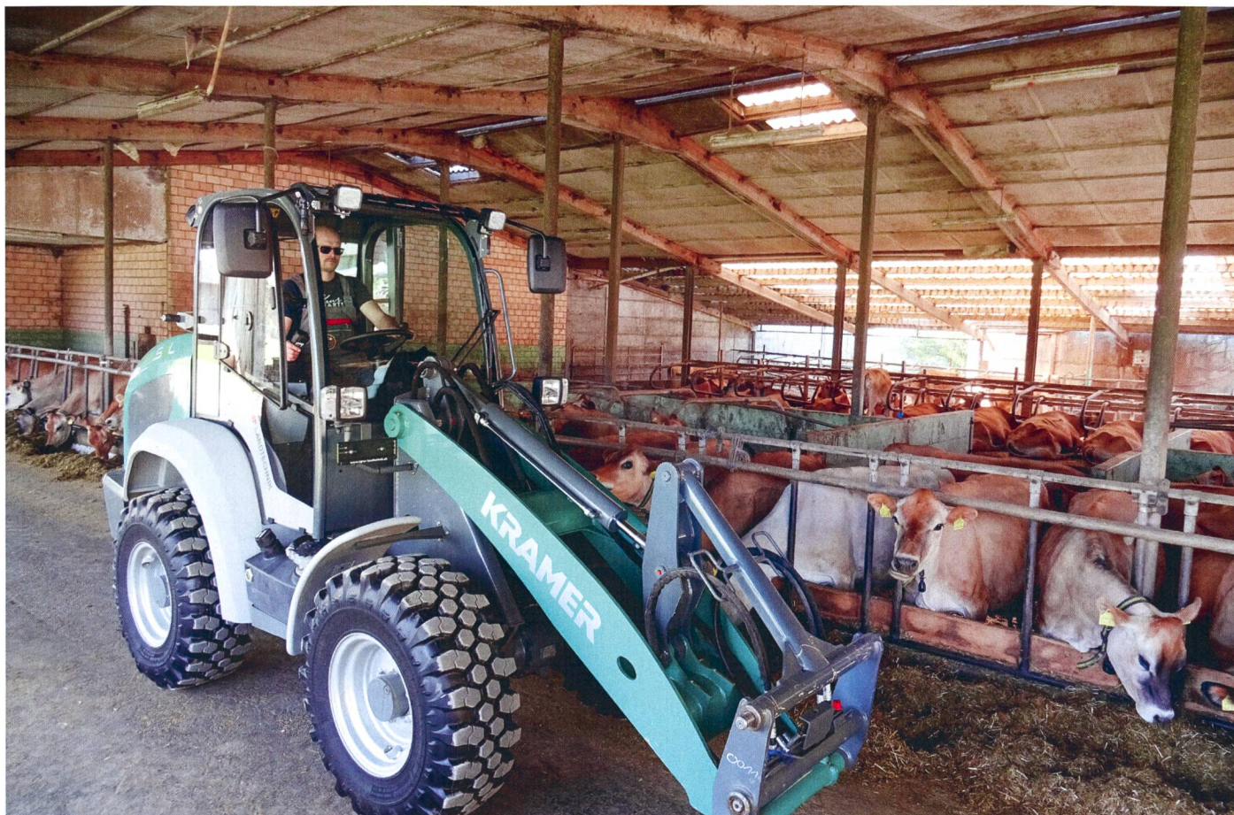
Le silence de fonctionnement et surtout l'absence d'émissions du « KL 25.5e » constituent des avantages prépondérants pour les hommes et les animaux lors de travaux à l'intérieur des bâtiments. Photos: Roman Engeler
