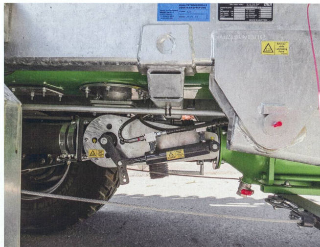
Cette vanne trois voies permet de régler la quantité de lisier dirigée vers le distributeur et la part de lisier brassée dans la citerne.
