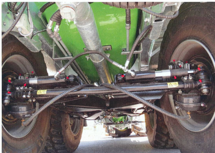
Le châssis doté d'un essieu suiveur a fait ses preuves. Une direction forcée peut facilement être installée à posteriori.
