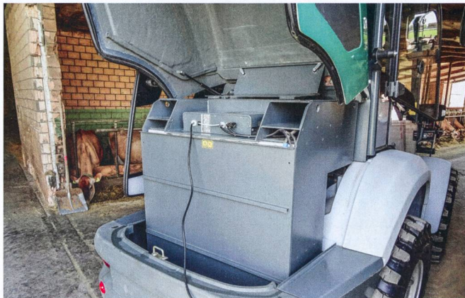
La batterie «AGM» avec son dispositif de charge se trouve à l'arrière. L'ensemble du «paquet» sert de contrepoids.
