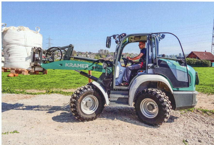
Aucun problème avec des balles pesant jusqu'à 1750 kg : le « KL 25.5e » avec palettiseur est photographié en pleine action.
