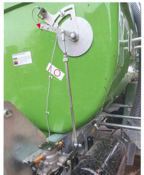
Le dispositif automatique de remplissage est géré par un capteur situé la jauge de remplissage tout comme le réglage automatique des freins en fonction de la charge.
