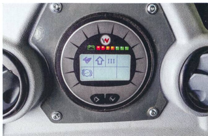
Le niveau de charge est affiché au tableau de bord sous forme de diodes lumineuses (rouge-orange-verte).
