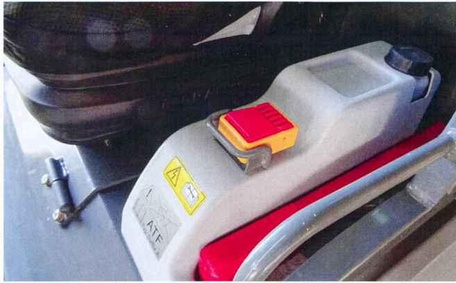
Le bouton d'enclenchement et de déclenchement du chargeur est placé à gauche du siège conducteur de la machine.
