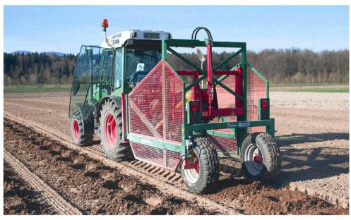
Le dispositif de pilotage électronique de la planteuse peut intervenir sur la marche du tracteur, qui avance automatiquement au prochain point de plantation.
