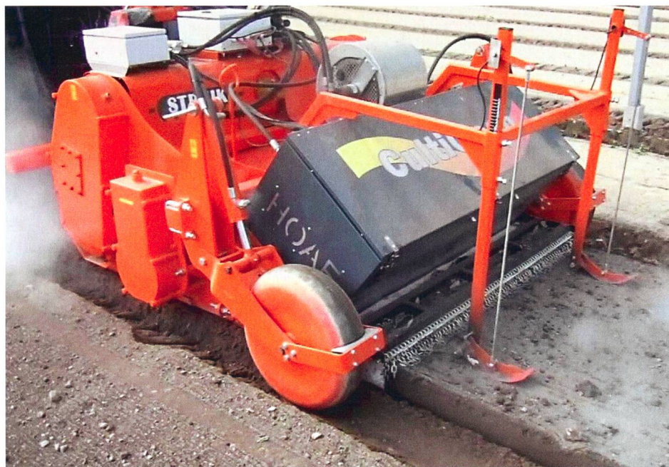
«CultiClean» est un procédé qui nous vient des Pays-Bas. La terre prélevée par deux rotors tournant en sens inverse traverse la flamme d'un brûleur à gaz. Photo: Struik (NL)
