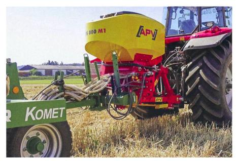
Le principe est identique mais la trémie et la largeur de travail sont plus grandes: ce semoir pneumatique professionnel dessert des outils traînés de préparation du sol. Photo: APV
