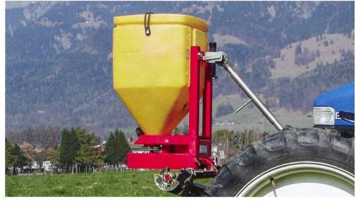
L'épandeur classique à granulés anti-limaces s'installe en un tour de main sur le tracteur. Photo: Ruedi Hunger
