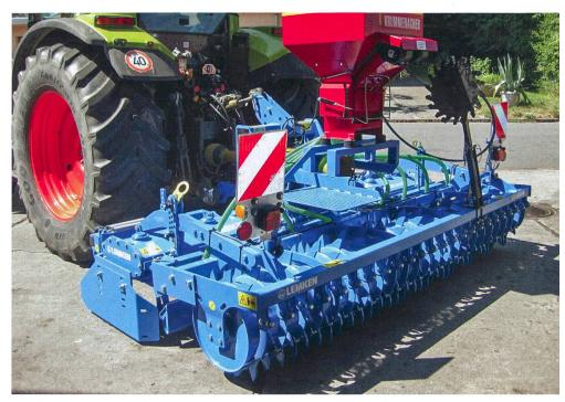
Dans le langage courant, le nom de «semoirs Krummenacher» a lontemps désigné les semoirs pneumatiques installés sur les outils de travail. Photo: Krummenacher
