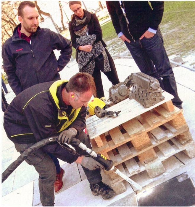
Démonstration du procédé de nettoyage à la neige carbonique (Ice-Blaster). Photos : Idd et Dominik Senn
