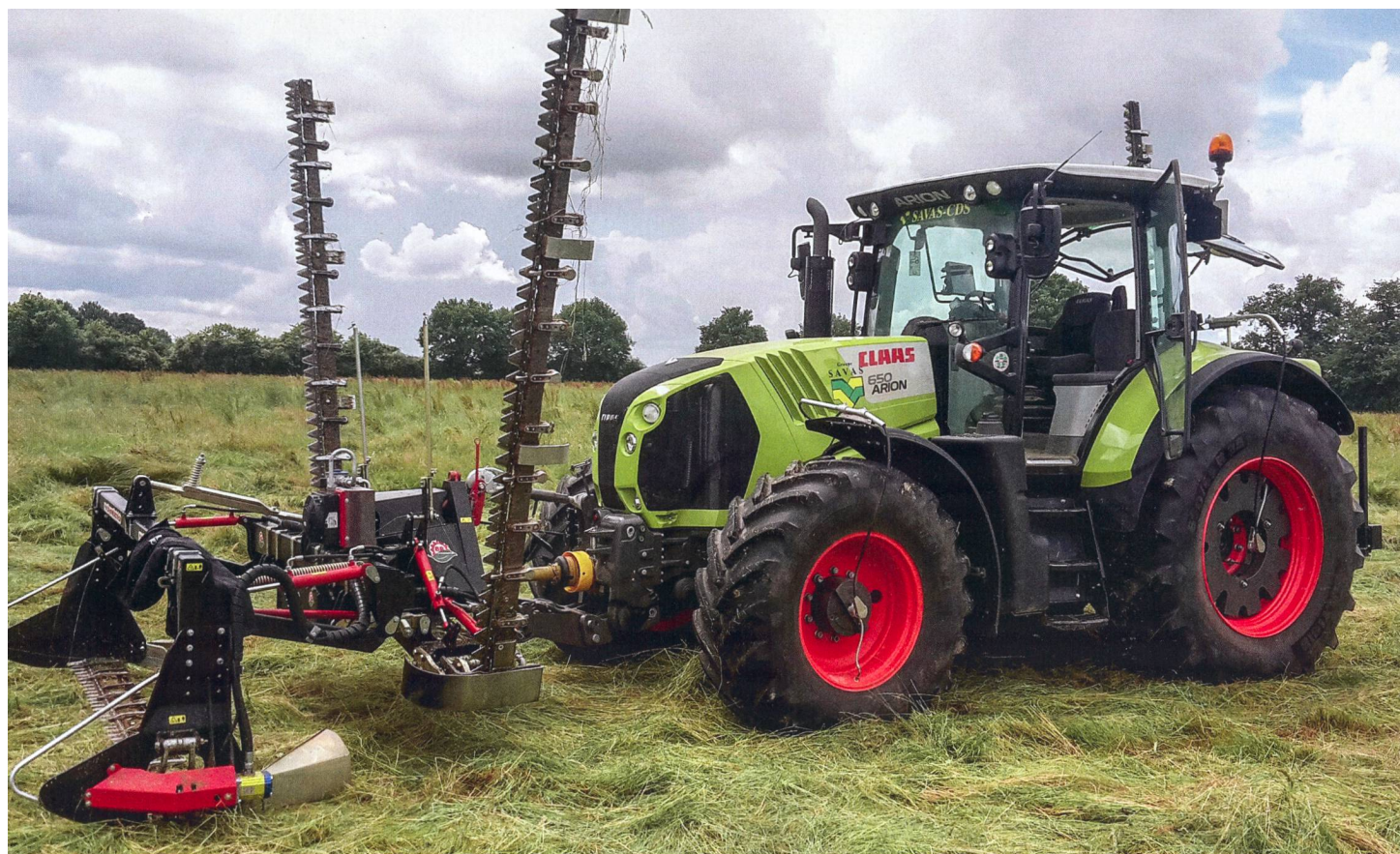
Plutôt que d'associer des machines frontales et arrière, il existe des barres de coupe utilisables en attelage frontal ou arrière, si l'on dispose d'un poste de conduite inversable. Photo : BB-Umwelttechnik
