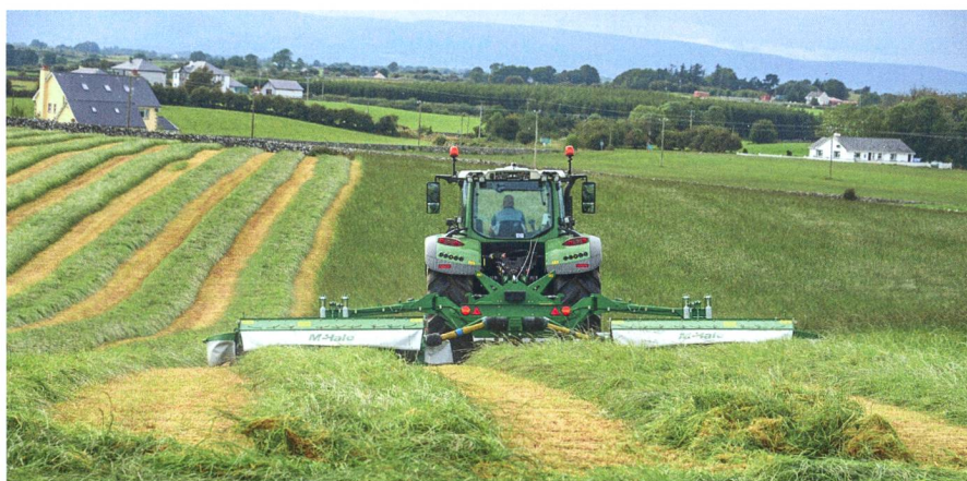
Les besoins en puissance d'une combinaison de faucheuses à disques sont relativement élevés. Elles permettent toutefois de travailler plus vite (jusqu'à 15 km/h). Photo : McHale
