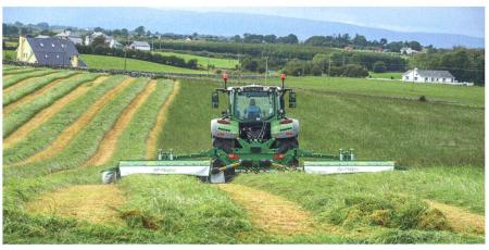
Les besoins en puissance d'une combinaison de faucheuses à disques sont relativement élevés. Elles permettent toutefois de travailler plus vite (jusqu'à 15 km/h). Photo: McHale
