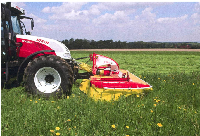
Même avec un tracteur de puissance moyenne, le porte-à-faux avant maximal est dépassé quand on lui attèle une faucheuse frontale.
