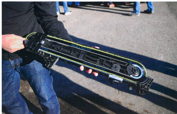
Les bandes de brosse sont intégrées dans une console en plastique. Cette dernière s'ouvre vite et sans outil grâce à sa fermeture rapide.
