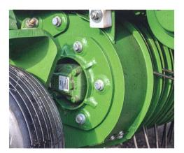
L'entraînement hydraulique du pickup est intégré dans ce cylindre.
