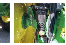
La suspension de cabine mécanique augmente le confort du conducteur.
