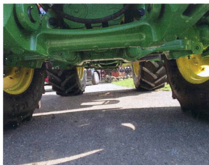
Avec son carter d'huile intégré par coulée, le nouveau châssis permet un centre de gravité bas.
