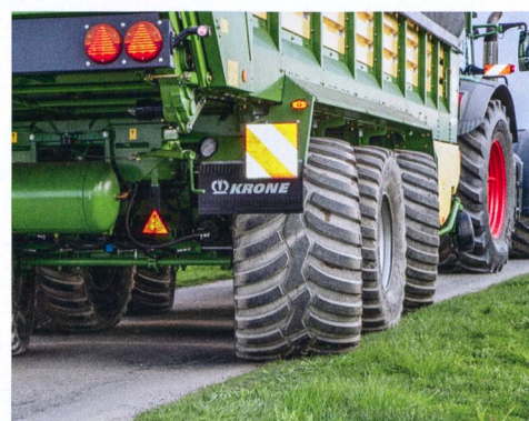
La marche en crabe peut servir à s'éloigner du bord du silo-couloir une fois l'essieu central légèrement relevé.
