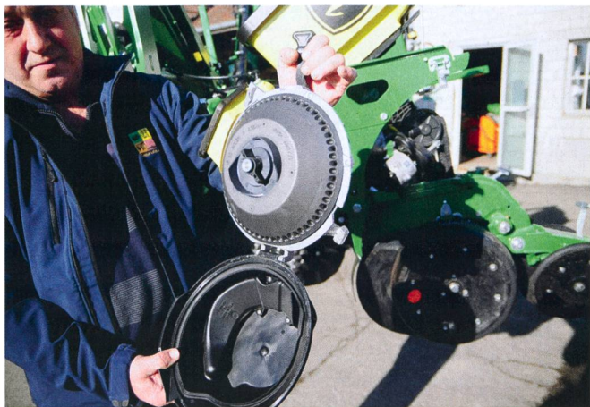
Les trous des disques comportent une encoche qui aide à maintenir les semences en place.
