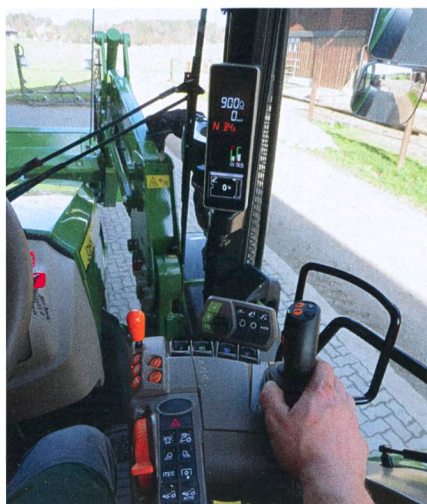
L'accoudoir regroupe les principales commandes. Le nouvel écran est intégré dans le montant A. Il remplace le tableau de bord.
