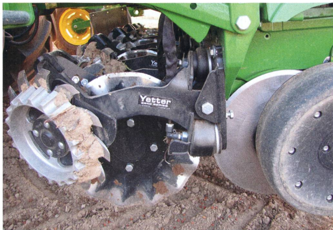
Il est possible de régler pneumatiquement l'intensité de travail des roues chasse-débris de marque Yetter.
