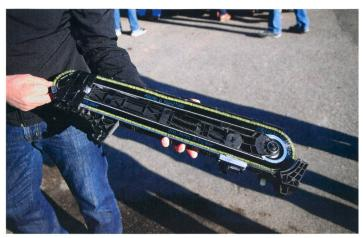
Les bandes de brosse sont intégrées dans une console en plastique. Cette dernière s'ouvre vite et sans outil grâce à sa fermeture rapide.
