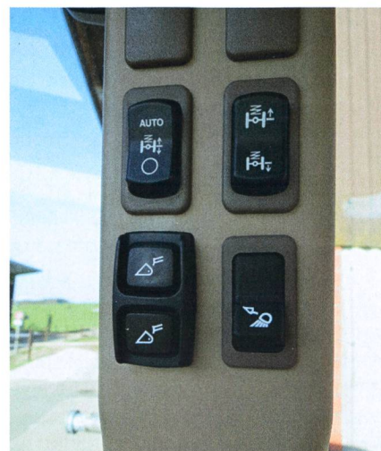
Le montant B regroupe les commandes de la suspension de l'essieu avant, du verrouillage d'outils et des phares du chargeur frontal.
