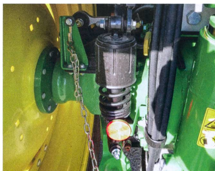
La suspension de cabine mécanique augmente le confort du conducteur.
