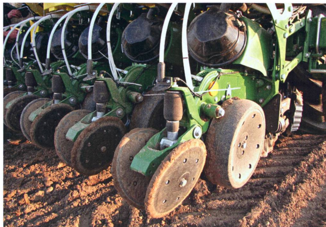
La pression au sol et le raffermissement sont aussi commandés pneumatiquement. Les conduites de dosage des engrais liquides et des antilimaces sont ici visibles.
