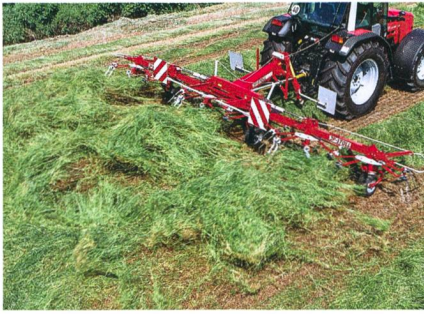
Cause 2: malgré un séchage conséquent, le régime du second passage de pirouette est trop élevé. Photo: JF-Stoll
