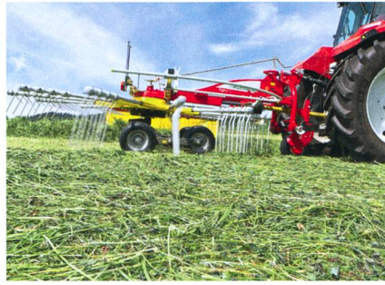
Cause 3: dans le but de récolter jusqu'au dernier brin de fourrage, les andaineurs travaillent souvent trop bas. Photo: Pöttinger
