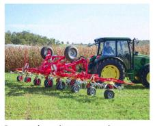
Pour que des petits tracteurs puissent également être utilisés, des châssis relevables ont été mis au point.
