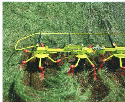
**Grâce à la conception tangentielle des bras porte-dents, le prélèvement et la répartition du fourrage sont optimisés.**
