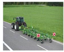
Certains constructeurs proposent également des grandes faneuses sans châssis spécial et qui se replient longitudinalement pour le transport. Photo: Krone
