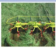
Grâce à la conception tangentielle des bras porte-dents, le prélèvement et la répartition du fourrage sont optimisés.
