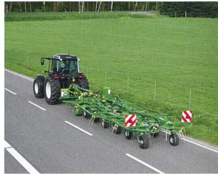
**Certains constructeurs proposent également des grandes faneuses sans châssis spécial et qui se replient longitudinalement pour le transport.** Photo : Krone
