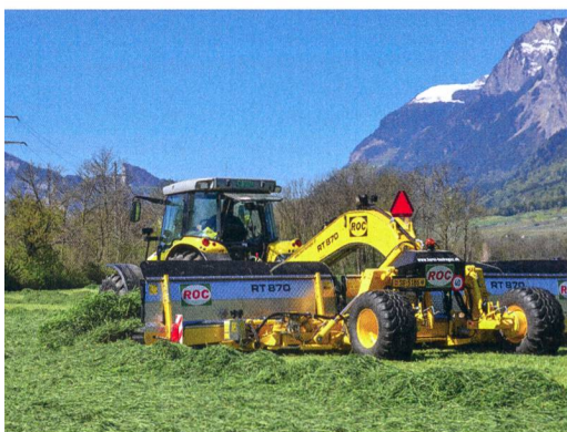
Les andaineurs à bandes, relativement rares, mélangent particulièrement le fourrage. Photo: R. Hunger
