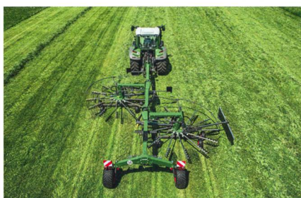
Andaineur latéral avec châssis de transport. Le relevage des toupies rend la machine étroite, mais d'autant plus haute. Photo : Fendt
