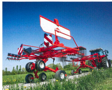
Andaineur latéral sans châssis spécial. La hauteur ne pose pas problème, contrairement à la largeur. Photo : Kuhn
