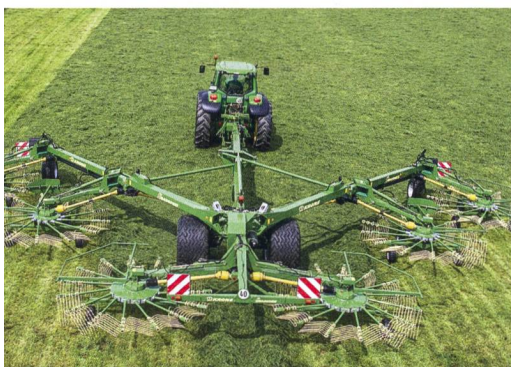
L'andaineur à six toupies est une machine professionnelle adaptée à l'ensilage. Photo: Krone
