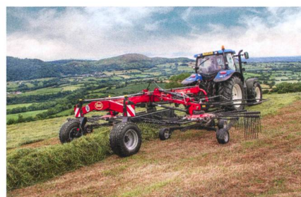
L'andaineur central classique a une largeur de travail déterminée, indépendante du volume de fourrage. Photo : Kverneland
