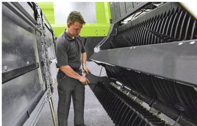
Sur les Claas « Cargos » de dernière génération, les couteaux à double tranchant peuvent être retournés ou remplacés confortablement grâce au plancher escamotable de la remorque.
