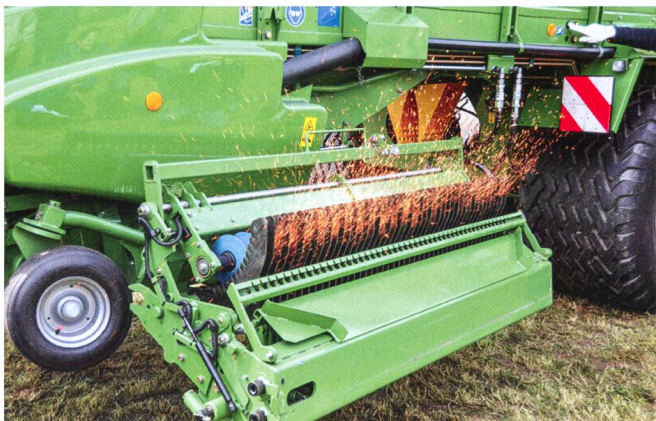
Le dispositif d'aiguisage Krone « Speed Sharp » utilise des disques à lamelles et permet de réaffûter l'ensemble des couteaux en deux minutes.
