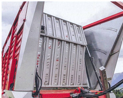
La paroi avant multifonctionnelle de Lely est disponible sur la gamme des grandes auto-chargeuses «Tigo». Elle facilite les opérations de chargement, de déchargement et libère de l'espace.
