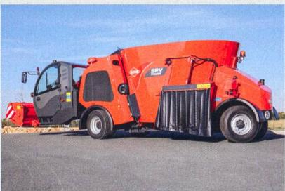
machines particulièrement compactes et de faible hauteur. Les modèles de 12, 14 et 15 m<sup>3</sup> (« Access ») et de 12, 14, 15 et 17 m<sup>3</sup> (« Power ») sont dotés d'un essieu arrière directionnel offrant un rayon de braquage réduit. La trémie placée entre les deux essieux repose sur un châssis. Le niveau de la trémie peut ainsi être surbaissé. La hauteur totale de la machine en version 15 m<sup>3</sup> reste ainsi en dessous de 3 mètres.
