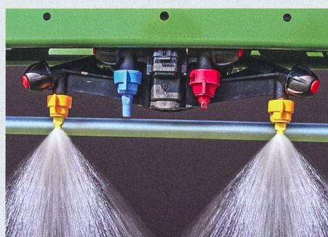
entre la rampe et la cible. Le changement de buses se fait électriquement, confortablement, depuis la cabine du tracteur.
