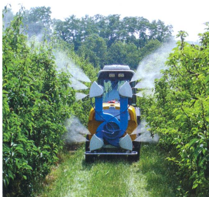
Techniques à appliquer: utiliser notamment un tracteur avec cabine fermée et un système de dosage automatique.
