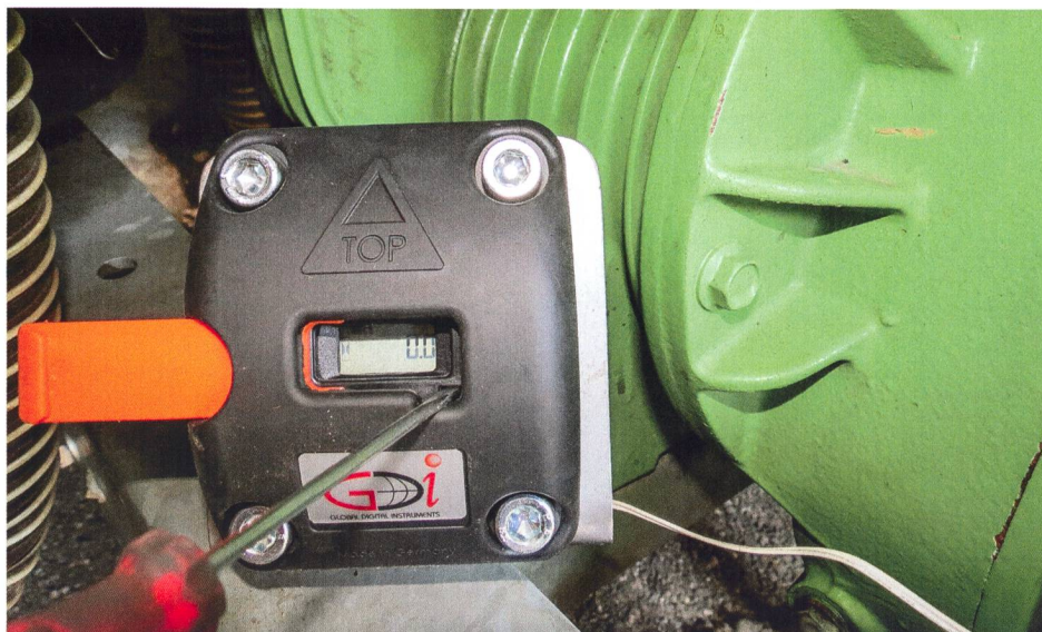
L'afficheur mesurant 5 x 2 cm est facile à lire. Un volet le protège contre les chocs, l'encrassement et l'humidité. Photos : Martin Abderhalden
