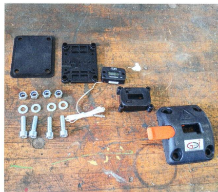
Constituant le cœur de l'appareil, le compteur est protégé par différentes coques.
