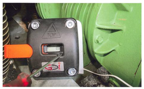
L'afficheur mesurant 5 × 2 cm est facile à lire. Un volet le protège contre les chocs, l'encrassement et l'humidité. Photos: Martin Abderhalden
