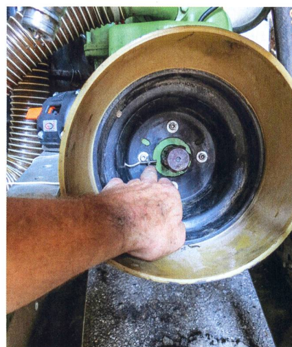
Distant de 3 mm au minimum, le capteur détecte les signaux de l'émetteur d'impulsions (aimant) qui est fixé sur la partie tournante.
