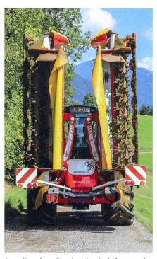
Avec l'attelage 3-points étroit, la largeur de la faucheuse est limitée à 2,70 m.
