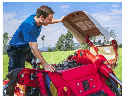
Le bloc de soupapes avec poussoir d'urgence et les indications d'entretien se trouvent sous le capot.
