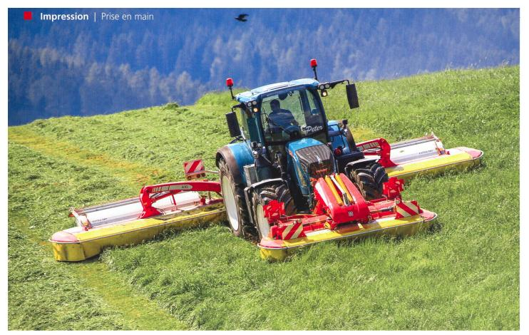
Pour que la «Novacat A10» atteigne la largeur maximale de 10 m, il faut disposer d'une faucheuse frontale de 3,50 m. Photos: A. et C. Leitner
