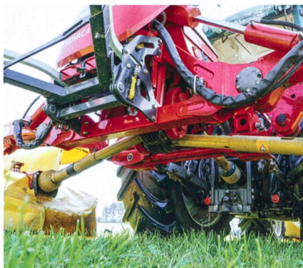
Le nouvel entraînement «Y Drive», avec arbre de transmission long, fonctionne silencieusement.
