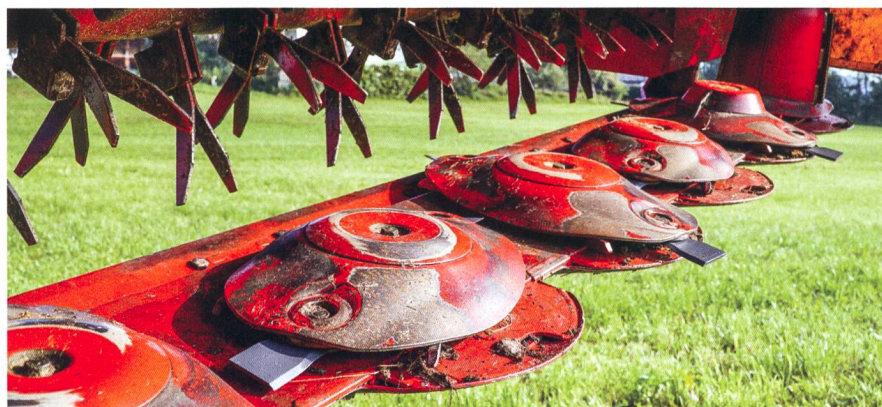
Le lamier de fauche éprouvé « Novacat », avec sa surface lisse et ses couteaux intégrés, fauche très proprement.
