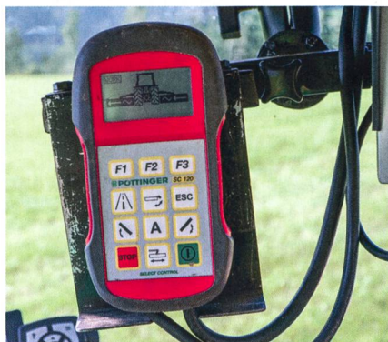
De série, la combinaison de fauche se commande grâce au terminal «Select Control». Isobus est en option.
