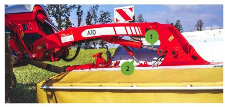
Bras massifs: (1) réglage hydraulique de largeur de coupe, (2) cylindre de stabilisation empêchant l'oscillation au levage.
