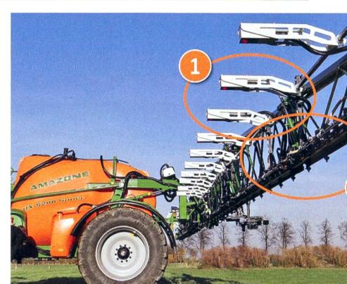
Le système «AmaSpot» d'Amazone est constitué d'une ouverture de buse commandée par capteur (1) associée à une technologie de réduction de la dérive (2). Il s'agit d'une première étape dans le «Farming 4.0». Image: Amazone
