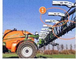
Le système «AmaSpot» d'Amazone est constitué d'une ouverture de buse commandée par capteur (1) associée à une technologie de réduction de la dérive (2). Il s'agit d'une première étape dans le «Farming 4.0». Image: Amazone
