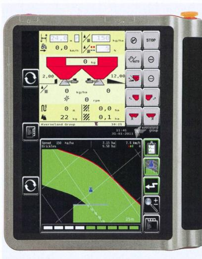
sur la courbe d'épandage. Pour éviter les sur- ou sous-dosages dans les bouts de champ, l'épandeur s'arrête et s'enclenche automatiquement à la hauteur de la tournière.
