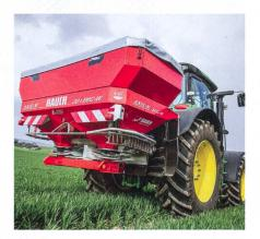
système mesure et régule automatiquement le débit d'engrais en temps réel aux trappes gauche et droite. Ce dosage automatique fait appel au rapport proportionnel existant entre le débit et le couple des disques d'éjection.
