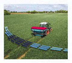
ne laisser ouverts que les deux tronçons centraux. En agriculture de précision, la modulation au sein d'une parcelle se fait en régulant le débit sur la foi des données GPS, à gauche et à droite. L'ensemble des processus, du système de pesée jusqu'à la modulation gauche-droite, en passant par la gestion de la nappe, est géré par le terminal « Quarz 800 » du constructeur. L'épandeur est utilisable avec tous les tracteurs, qu'ils soient ou non équipés Isobus.
