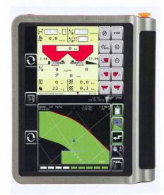
sur la courbe d'épandage. Pour éviter les sur- ou sous-dosages dans les bouts de champ, l'épandeur s'arrête et s'enclenche automatiquement à la hauteur de la tournière.
