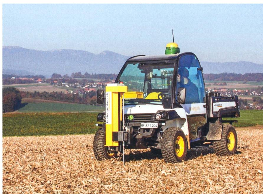
Ce «Gator 825i» de John Deere est utilisé pour le prélèvement d'échantillons de sol et pour la mesure des parcelles. La puissance hydraulique est fournie par un moteur embarqué.
