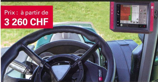
En tant que système de guidage parallèle de dernière génération, le TRACK-Guide III dispose d'un écran 8" tactile capacitif. Le TRACK-Guide III autorise un grand nombre d'extensions telles que l'autoguidage ou son utilisation comme terminal ISOBUS à part entière pour le traitement des missions et la commande automatique des tronçons.
