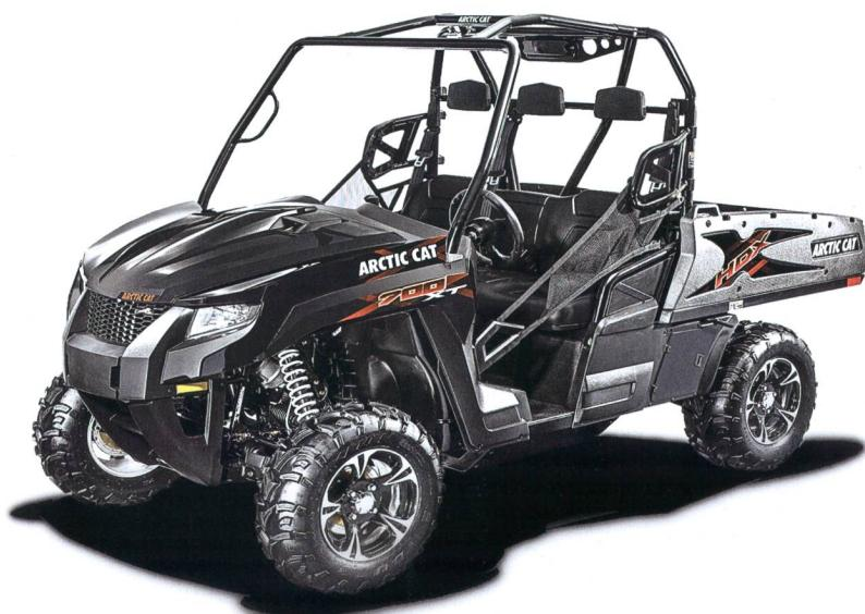
Grâce à son blocage du différentiel du pont avant à commande électronique, la série side by side « Prowler » d'Arctic Cat présente des capacités de traction particulièrement élevées.
