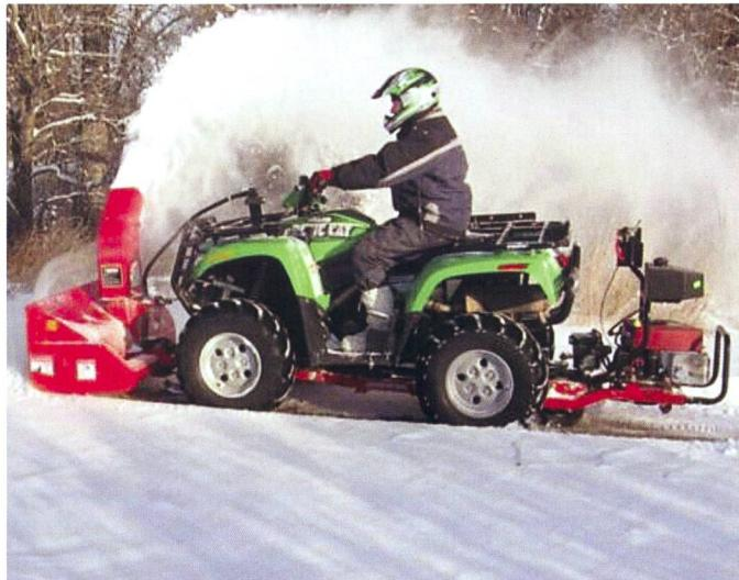
**Les outils portés demandant beaucoup de puissance nécessitent l'installation d'un moteur embarqué. La charge maximale est ainsi rapidement dépassée.**
