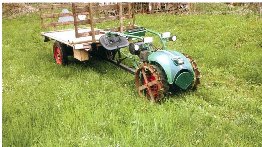
Le «MA 60» d'Aecherli avec ses roues à crampons, la solution de traction avant sur des pentes raides (ici, l'essieu arrière n'est pas entraîné).
