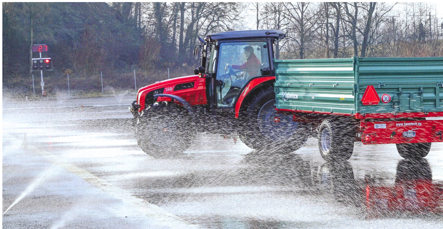
A grande vitesse, le freinage d'évitement (ici, le signal indique d'éviter par la gauche) dépend entièrement du chauffeur. Photos: Dominik Senn
