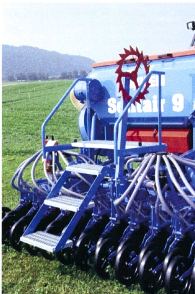
Les exigences pour un accès sûr, comme on le voit ici sur ce semoir, sont l'une des success-story de la standardisation.
