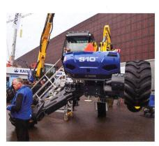
Perkins, qui intègre un filtre à particules, constitue le cœur de cette machine. Le bilan de performance de la pelle est défini par l'association du Kaisertronic et d'« ELIS » (Electonic Load Independent System). Les pompes de travail, d'avancement et de ventilation ont chacune leur propre circuit hydraulique. La vitesse d'avancement est réglable en continu entre 0 et 15 km/h.
