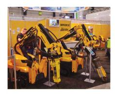
donc capable d'évoluer sur des sols ne supportant pas de charge importante. Son moteur développe un maximum de 16,5 kW et son système hydraulique affiche un volume de 45 litres. Il est recommandé d'utiliser des outils jusqu'à 160 kg.
