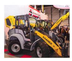
batteries de cette chargeuse permettent de réaliser cinq heures de travail. Leur chargement prend trois à six heures et l'énergie est stockée dans des accumulateurs plomb-acide.
