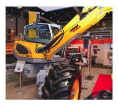
poids de sept tonnes. Son moteur affiche 55 kW (75 ch). La commande « APM » (Anticipating Power Management) permet une collaboration harmonieuse du moteur et de l'hydraulique. La « M2 » dispose d'un système hydraulique Load-Sensing.
