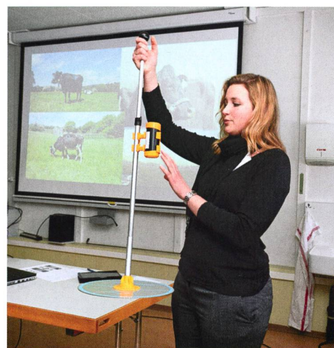
Ce capteur sert à mesurer la hauteur de croissance de l'herbe et à localiser les données par GPS sur une carte, afin d'adapter la gestion et la fertilisation aux besoins du pâturage.
