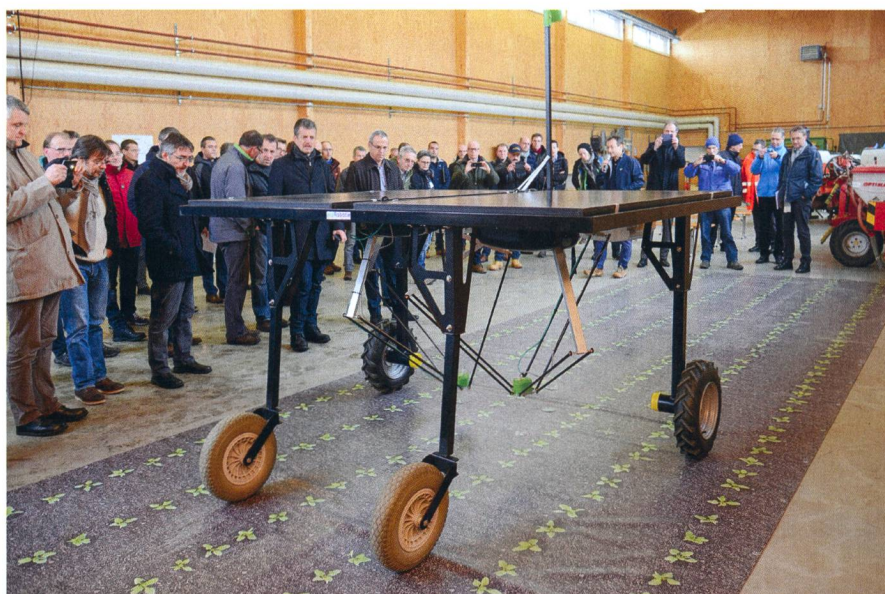
Destiné à un désherbage ciblé, le premier robot entièrement autonome de l'entreprise suisse Ecorobotix a été présenté à l'intérieur, quasiment dans des conditions de laboratoire.
