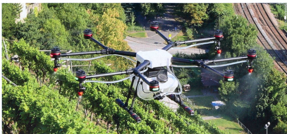
Les drones de pulvérisation pourraient constituer une alternative en cas d'interdiction des applications phytosanitaires aériennes. Photo : dronepart.de
