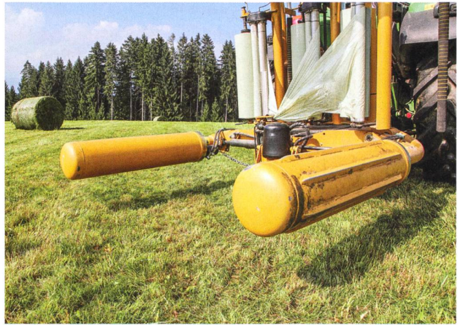
Les rouleaux d'enrubannage sont entraînés par deux moteurs hydrauliques séparés.
