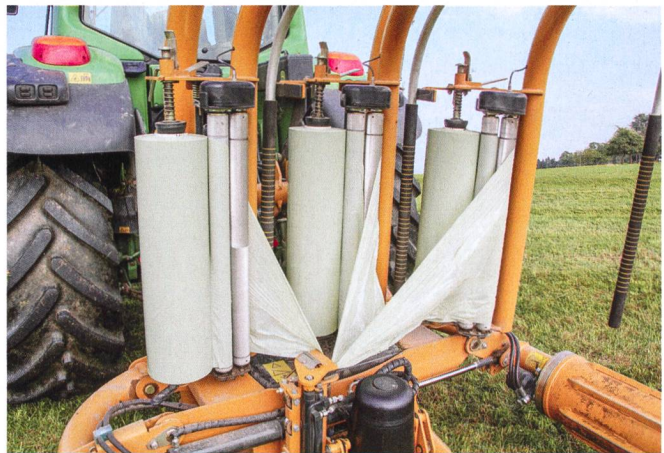
Les trois bras du «VariWrap S300» de Tanco se replient après chaque processus d'enrubannage achevé.
