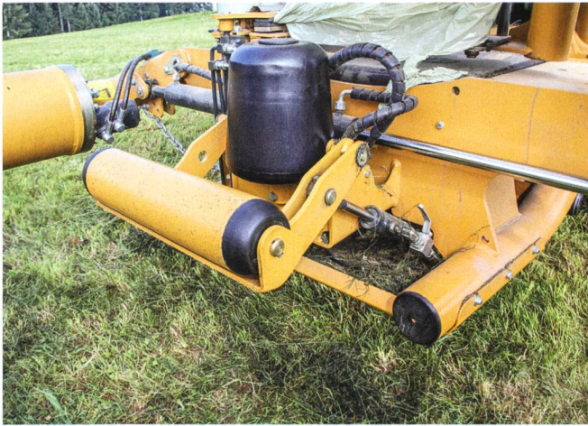
Un cylindre placé de biais sur l'enrubanneuse pousse le vireur de balle vers le haut.
