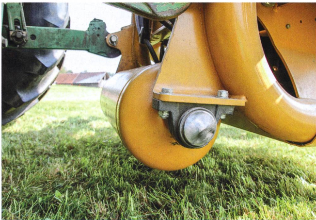
L'enrubannage peut également se faire en stationnaire grâce au rouleau de support au sol.
