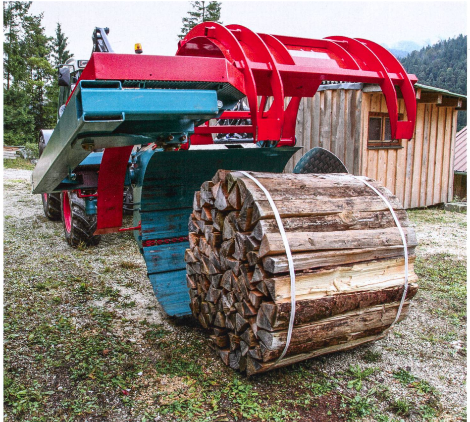
Les « boules » standard sont saisies directement par le grappin.
