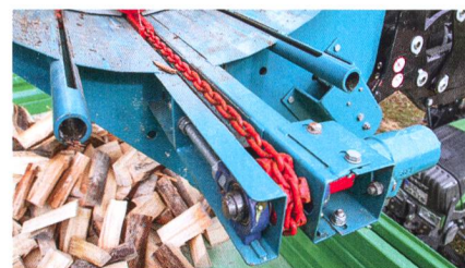
Système de poussée hydraulique en continu pour le réglage de la longueur de coupe, jusqu'à 50 cm de long.
