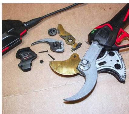
Quelques minutes suffisent pour changer la tête de coupe. Le kit « Maxi » est ici installé sur le sécateur.
