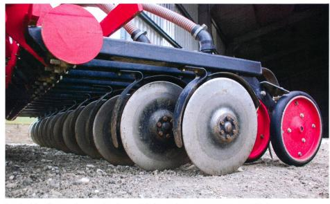
Les doubles disques, la roue plombeuse et la herse de recouvrement sont solidaires.
