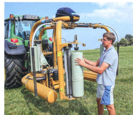
Le conducteur change les bobines de film en quelques minutes.
