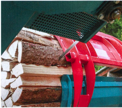
La scie à ruban ne génère pas d'esquilles ni de débris...
