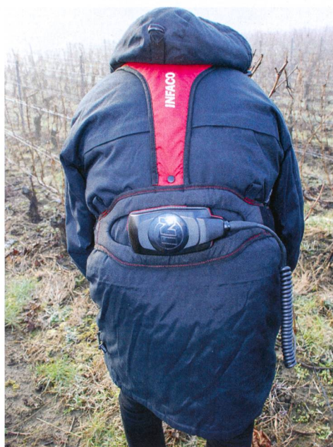
La batterie se porte soit sur le gilet transformable en ceinture, soit directement à la ceinture du pantalon ou dans une poche de veste.
