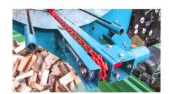
Système de poussée hydraulique en continu pour le réglage de la longueur de coupe, jusqu'à 50 cm de long.
