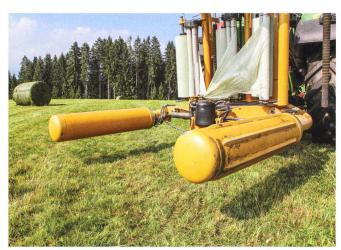
Les rouleaux d'enrubannage sont entraînés par deux moteurs hydrauliques séparés.
