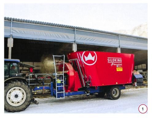
de paille hachée, le flux d'air important et la longueur d'éjection de 20 m sont à l'origine d'un dégagement de poussière important.
