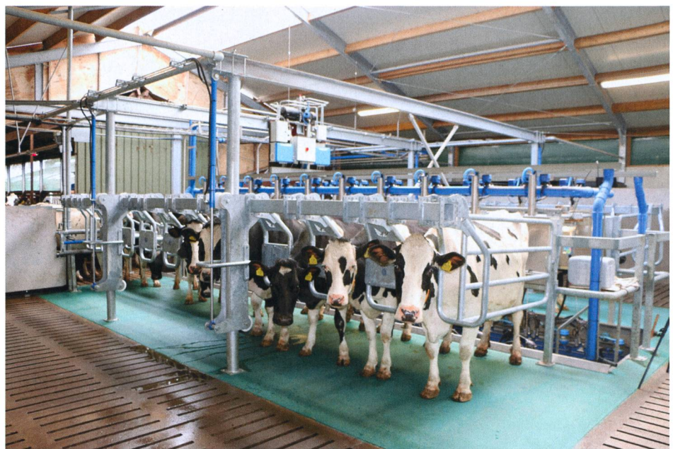
Salle de traite parallèle « Side-by-Side » avec sortie rapide « Quick-E » de Lemmer-Fullwood. Les portillons des stalles s'ouvrent verticalement. Photo : Lemmer-Fullwood
