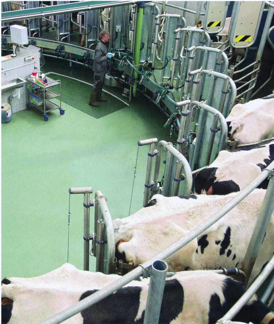
Avec un plancher mobile, la hauteur de travail peut être parfaitement adaptée au trayeur.
