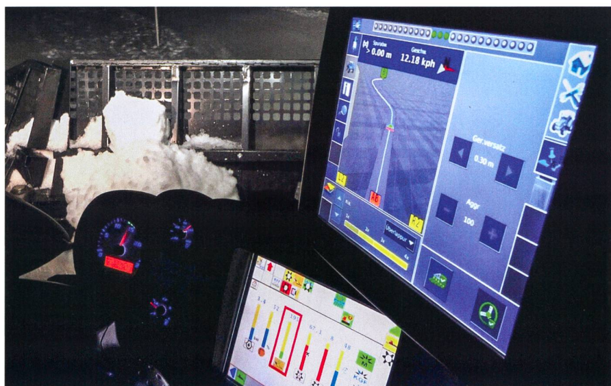
Le grand écran PLM permet au chauffeur de se repérer par rapport aux obstacles même de nuit.
