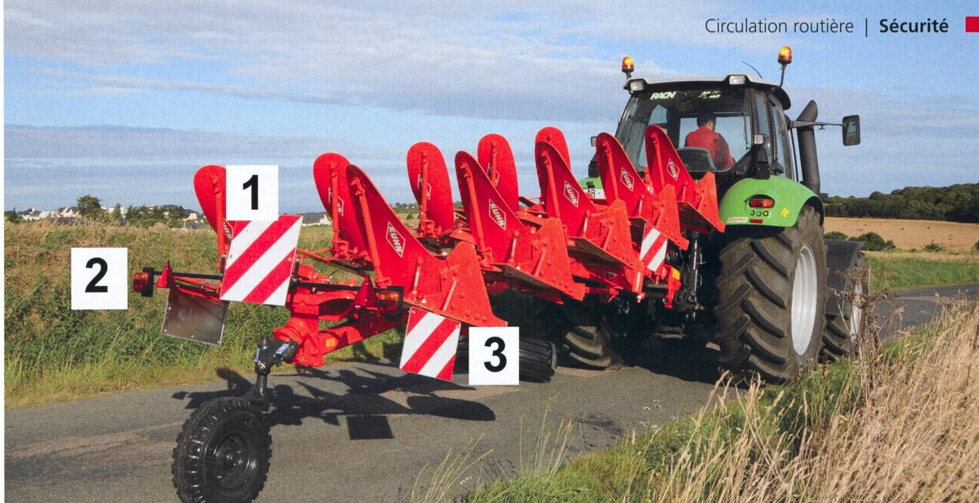
Cette charrue est considérée comme une remorque de travail. Dès lors, une installation d'éclairage complète sur panneaux réfléchissants (1), des catadioptres triangulaires (2) ainsi qu'une signalisation latérale (gauche et droite 3) sont nécessaires. Le triangle «véhicule lent» manque ici. Photo: Kuhn, montage de Ruedi Hunger
