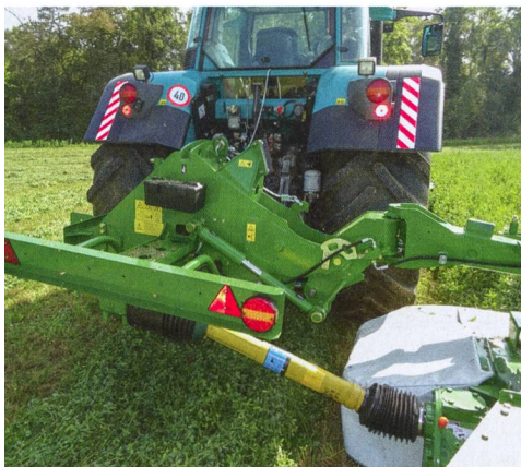
La faucheuse latérale « R3100 » pèse 1470 kg et dispose d'un éclairage installé sur un support massif.
