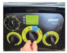
Le panneau de commande est muni d'un afficheur LCD, de témoins de niveau et de trois boutons rotatifs.
