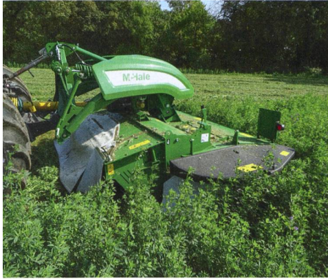
La faucheuse frontale possède son propre système de délestage par ressort. Elle est capable de s'adapter au sol sur 500 mm, indépendamment du tracteur.
