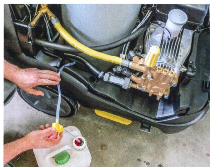
Un flexible d'aspiration intégré peut servir à aspirer du détergent à partir d'un récipient extérieur.
