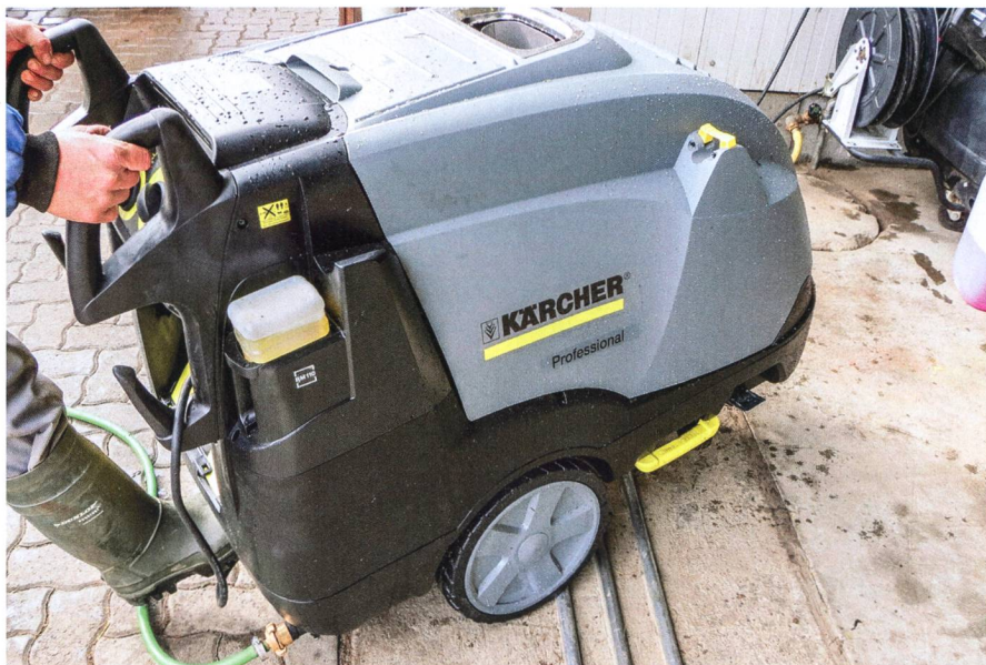
Le liquide d'entretien du système est introduit à l'aide d'une cartouche jetable.
