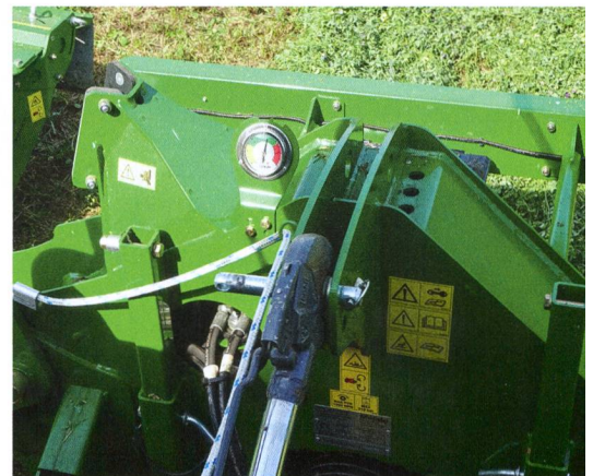
Un manomètre affiche la prétension hydraulique du délestage.
