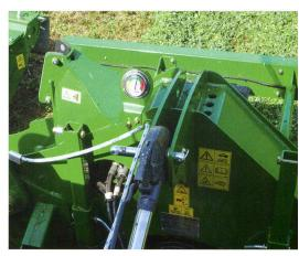
Un manomètre affiche la prétension hydraulique du délestage.
