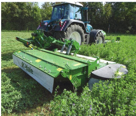
L'unité arrière se caractérise par son suivi du sol tridimensionnel qui autorise les mouvements vers l'avant et l'arrière.
