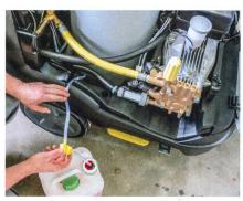
Un flexible d'aspiration intégré peut servir à aspirer du détergent à partir d'un récipient extérieur.
