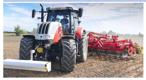
Lorsque l'appareil est associé à un outil de préparation du sol, ce dernier peut recevoir les données directement, lui permettant ainsi d'ajuster la profondeur de travail. Photos: Geoprospectors GmbH
