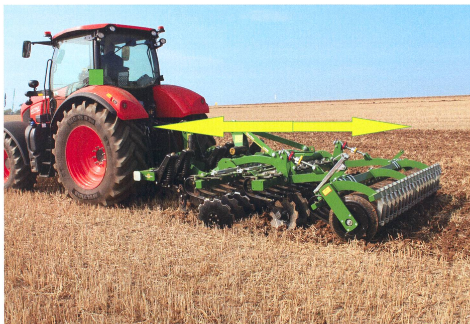
Plus l'outil est long, plus le poids du rouleau met le relevage à contribution.
